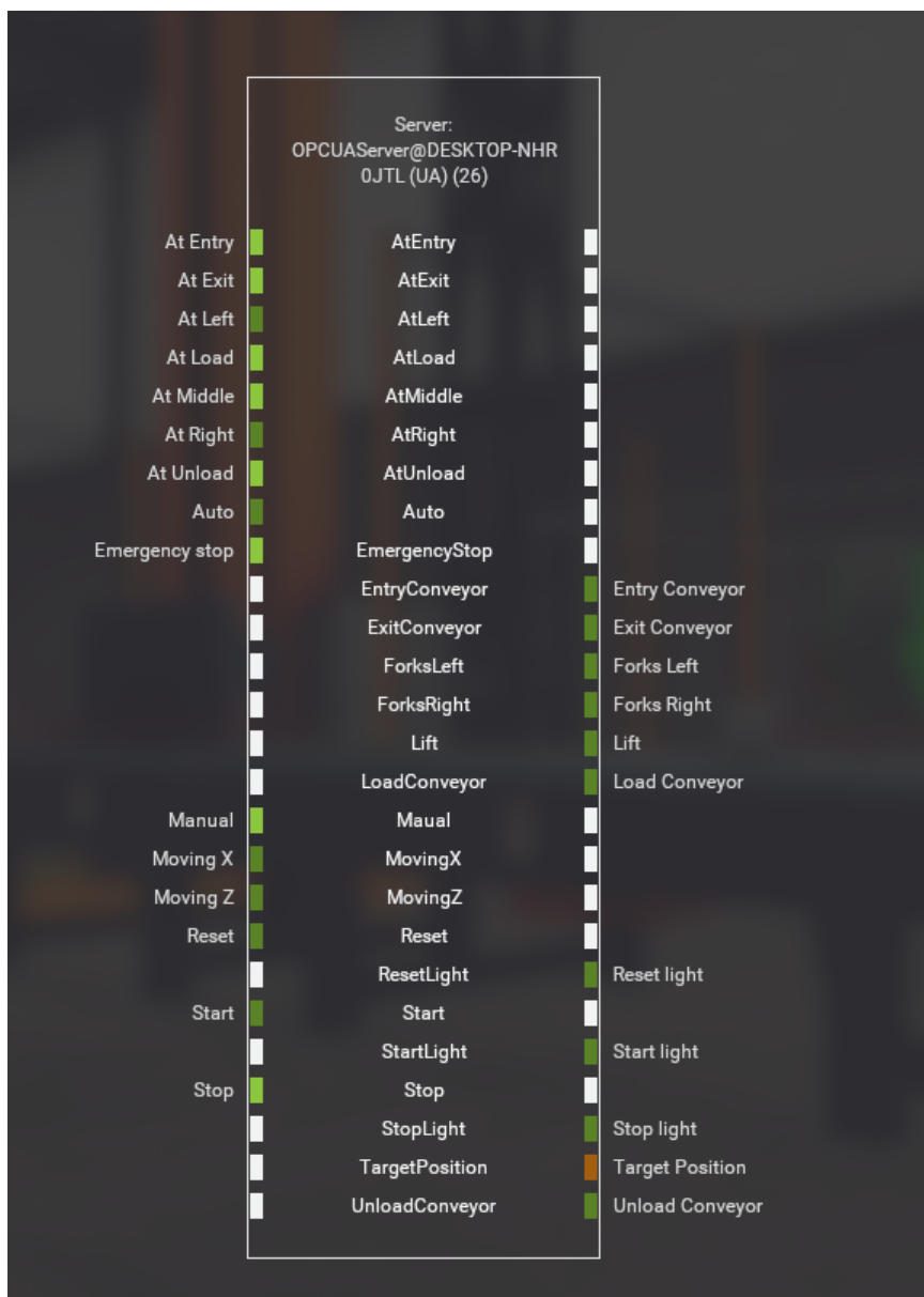
Obrázok č. 149: Mapovanie senzorov a aktuátorov vo Factory IO na OPC UA premenné [76]
