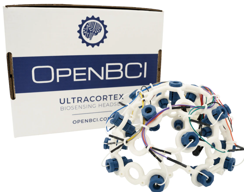
Obrázok č. 210: Open-source BCI zariadenie Ultracortex "Mark IV" EEG [71]
