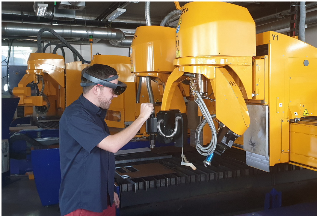
Obrázok č. 35: Testovanie rozšírenej a zmiešanej reality pre údržbu rezacieho stroja [56]
