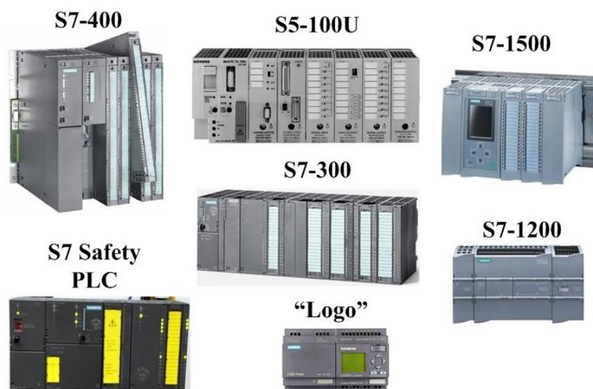
Obr. 3 Siemens PLC zariadenia [7]
