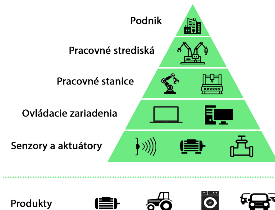
Obr. 1 Štruktúra internetu vecí. Podľa [4]
