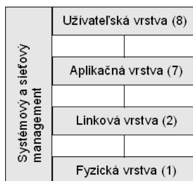
Obr. 4.1 Vrstvový model priemyselnej komunikačnej zbernice s vyznačením pozície vrstiev vo vrstvomom modeli OSI (užívateľská vrstva nie je súčasťou modelu OSI)
